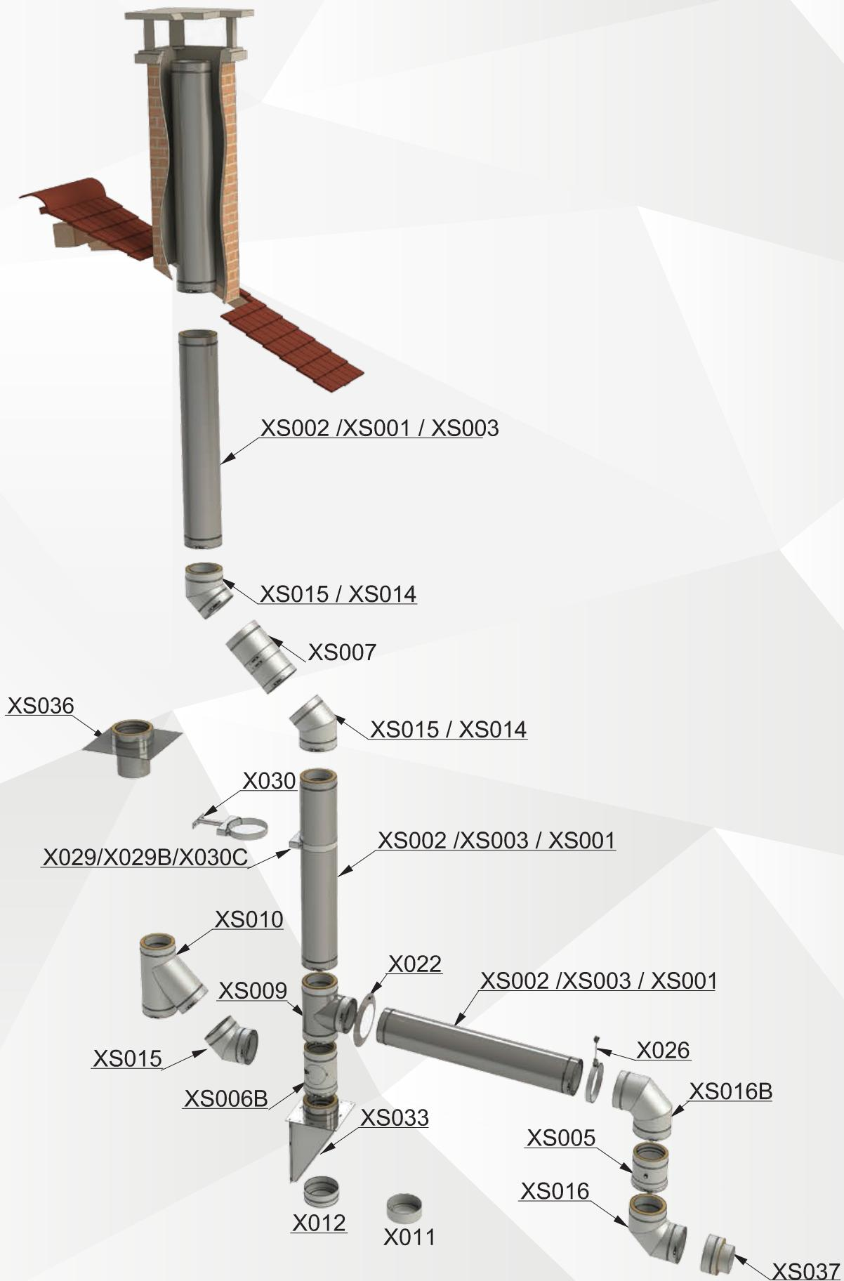
Cette vue d'ensemble des pièces est présentée à titre d'exemple et ne remplace en rien le dimensionnement de l'installation
